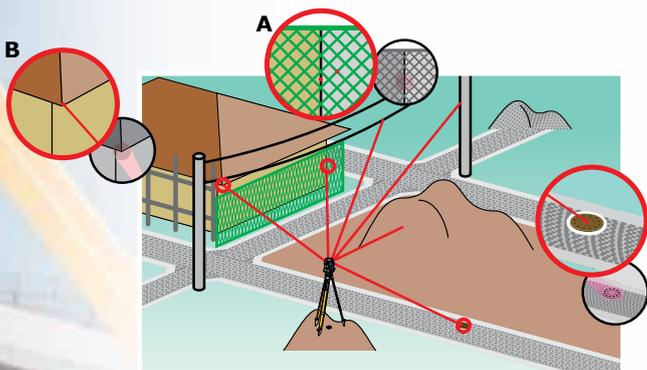
El haz ultra estrecho EDM puede medir con precisión paredes, esquinas, entradas de inspección en la superficie de las carreteras, incluso las cercas alambradas y las ramas de los árboles.
